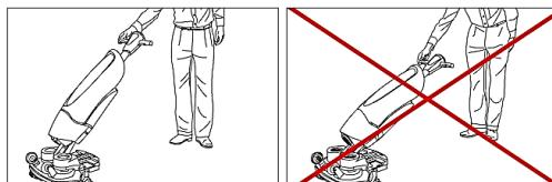
Конструкция щеточного узла обеспечивает максимально близкий доступ к стенам. Для этого нужно подвести торец машины i-тор к стене под некоторым углом, а затем продолжить работу вдоль стены.
