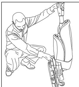
Медленно приподнимать щеточный узел до тех пор, пока он не установится на передние колеса; подтягивать корпус в сторону щеточного узла до тех пор, пока он не будет зафиксирован в устойчивом положении.
