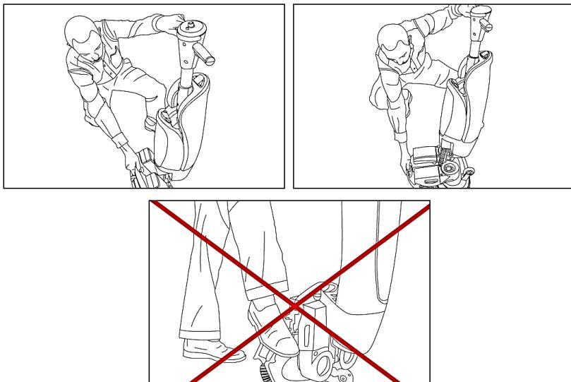
**Для опускания щеточного узла на пол запрещается использовать ноги.**
