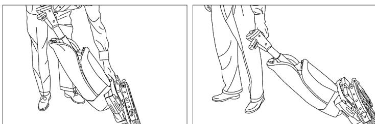
Если требуется загрузить машину i-tor в автомобиль или перетащить над препятствиями, нужно держать ее обеими руками. В этом случае нужно придерживать рукоятку одной рукой и приподнять щеточный узел другой рукой.
