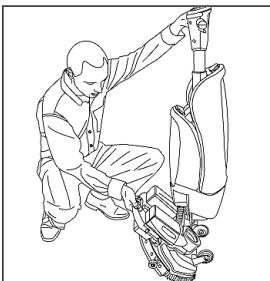
Убедиться, что машина i-тор установлена в месте, не препятствующем передвижению окружающих. Производитель рекомендует всегда устанавливать машину i-тор близко к стене, направив рукоятку к стене, а щетки - от стены. В таком случае, если кто-то заденет машину, она прислонится к стене.
